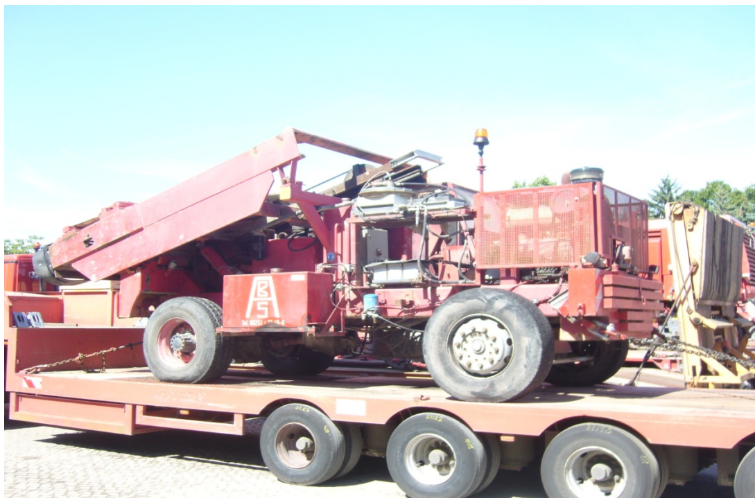
Betonzertrümmerer in Transportstellung mit umgeklapptem und gesichertem Fallgewicht
